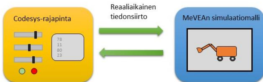
Kuva 1. MeVEAn ja Codesyksen yhteysratkaisu.
