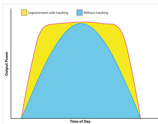
Kuva 12. Aurinkoa seuraavan järjestelmän tuottama teho verrattuna kiinteästi asennettuun järjestelmään. (IFC 2015)
