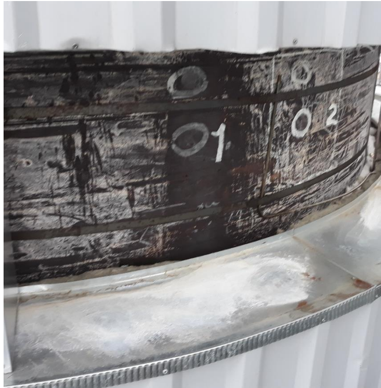
Kuva 26. EMAT-ultraäänelle määritellyt pisteet tarkasteltavan laitteen pinnalla.
