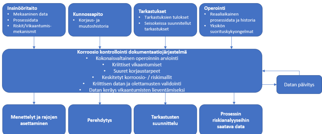
Kuva 27. CCD järjestelmän kehittäminen (mukaiillen Williamson, K. 2019, s. 16).
