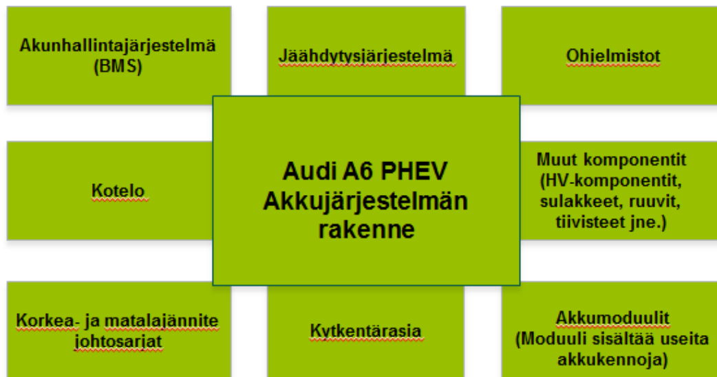
Kuva 4. Ajoneuvon akun pääkomponentit (Lehnert, 2017).
