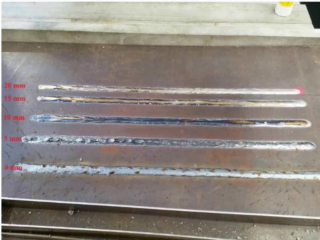
Kuva 10. Hitsisaumojen pintojen eroavaisuudet erilaisilla jauhekerroksen paksuuksilla.
