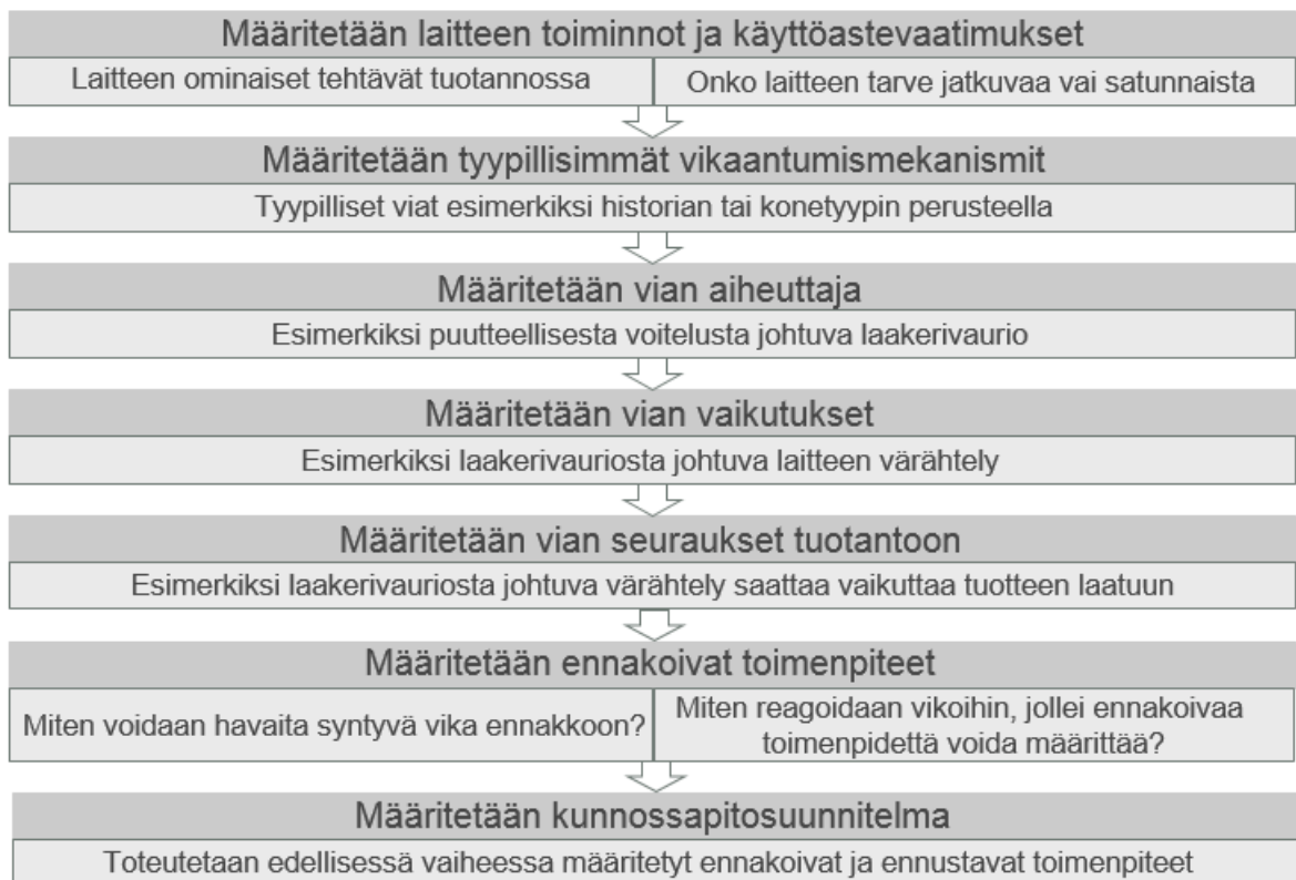
Kuva 13. RCM-analyysin vaiheet kunnossapitosuunnitelman laadintaan (muokattu, Manzini et al. 2010, 72-73)
