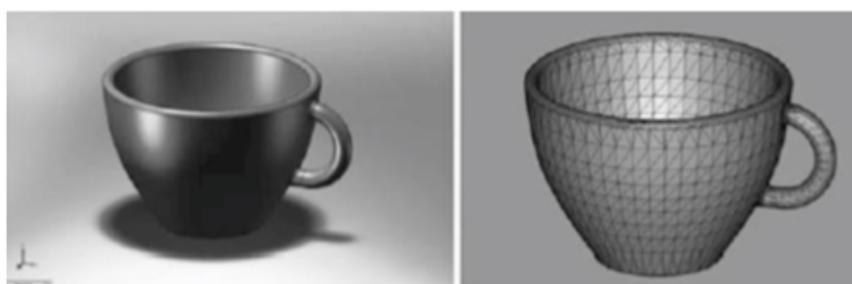
Kuva 1. Kappaleen CAD-malli muutettu STL-formaattiin (Gibson et al. 2015 s. 25)
