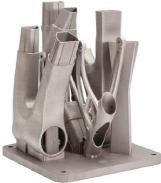
Kuva 9. Polkupyörän rungon komponentit valmistuskierron jälkeen, materiaalina titaani. (Milewski 2017, s.12)
