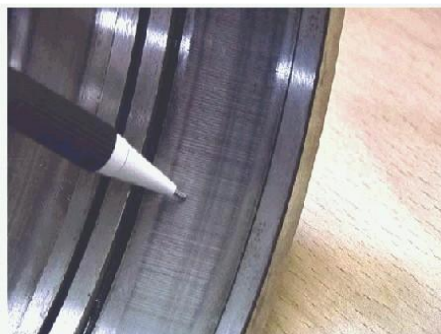
Kuva 21. Taajuusmuuttajakäytön aiheuttaman laakerivirran synnyttämä laakerivaurio, ns. pyykkilautakuvio (Lindgren 2003, Kunnonvalvonta ja ennakoiva kunnossapito –seminaari CD-ROM)
