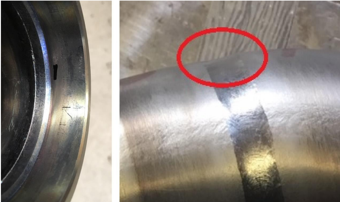
Kuva 10. Visuaalisessa tarkastuksessa vasemmalla kuvassa yksi havaittu vajaa juuri ja oikealla vajaa kupu.
