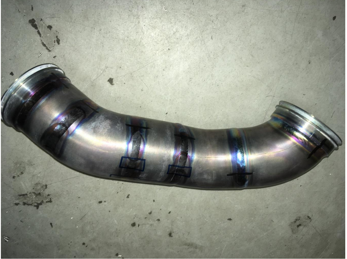
Kuva 11. Koehitsattu putki lämpökäsittelyn jälkeen
