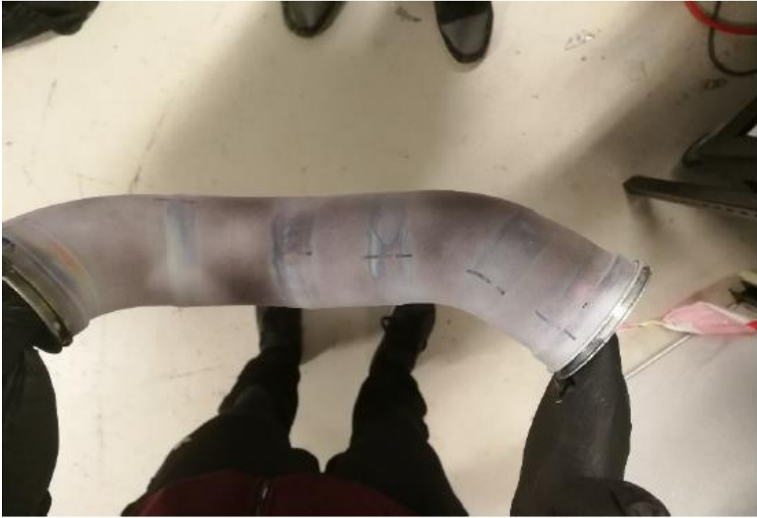
Kuva 12. Tunkemanestetarkastus koehitsattuun putkeen
