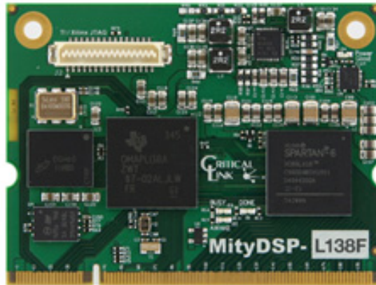
Kuva 5: Critical Link LLC:n valmistama MityDSP-L138 prosessorilevy, jossa on ARM-suoritin sekä Spartan-6 FPGA
