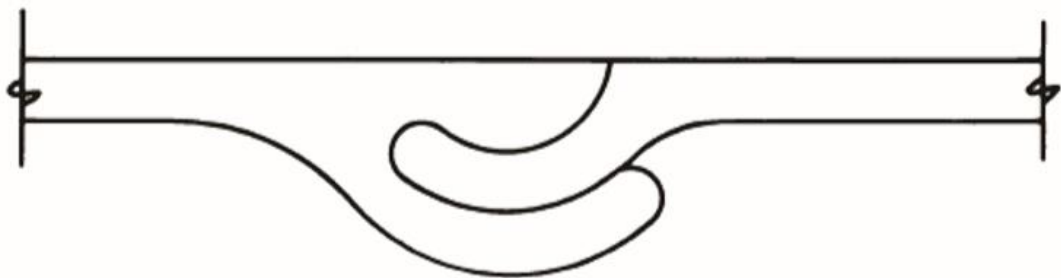
Kuva 12. Lomittaislukittuva saranaliitos (Mukaiillen Aluminum Extrusion Manual 2018, 6-14)
