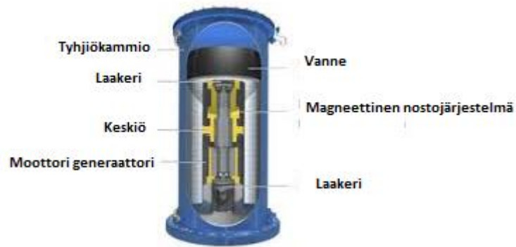
Kuva 3. Vauhtipyöräjärjestelmän rakenne. (Flywheel Energy Storage. 2013)
