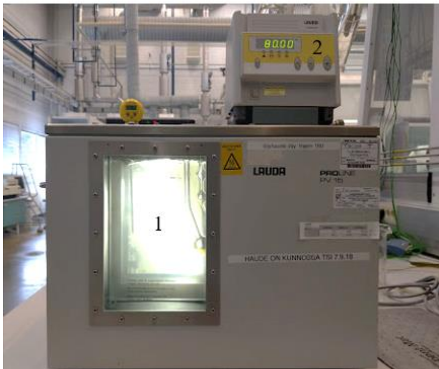
Kuva 12 Viskohaude, jossa kapillaari upotettuna lämpimään hauteeseen (1), joka on säädetty säätöyksiköstä (2).
