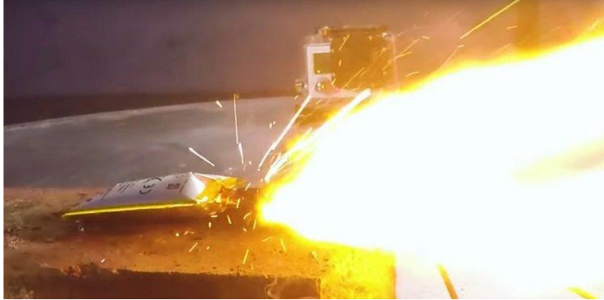
Kuva 4.1 Kuvassa litiumioniakun lämpökarkaamisesta johtuva reaktio. Kyseisessä kuvassa akusta on poistettu suojaava piiri ja sitä ylliladattiin. (Electronics 360, 2019)
