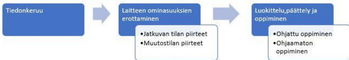
Kuva 4. NILM-järjestelmän yleinen toimintaperiaate
