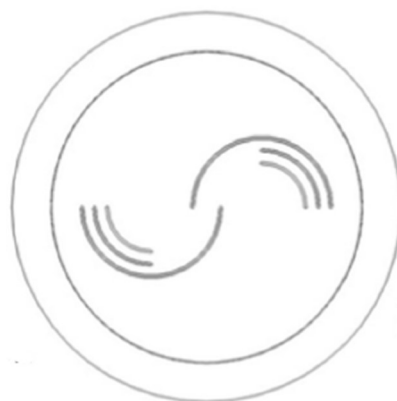
Kuva 12. Neljännessiivillä varustettu Savonius-turbiini (Sharma & Sharma 2016).
