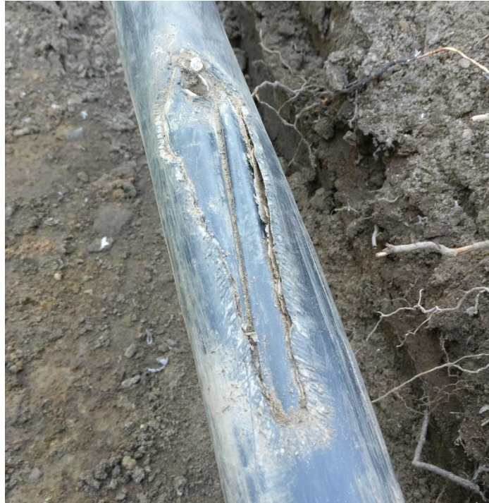
Kuva 2.1. Vikaantunut 20 kV APYAKMM 3x70 mm 2 . (Kakkonen, 2020)
