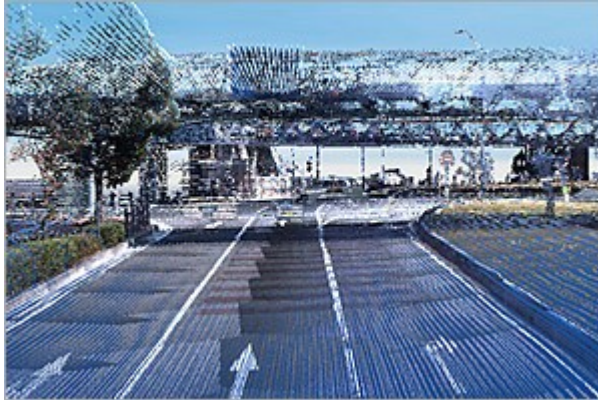
Kuva 6. Pistepilvidatan päälle asetettu kameran kuva mahdollistaa sen esittämisen värillisenä [14].
