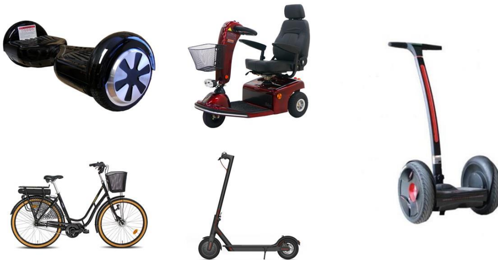
Kuva 3.1. Oheisessa kuvassa vasemmassa yläreunassa on sähköinen tasapainottelulauta, vasemmassa alareunassa on sähköpolkupyörä, keskellä ylhäällä on sähköinen apuajoneuvo, keskellä alhaalla on sähköpotkulauta ja oikeassa reunassa on segway.
