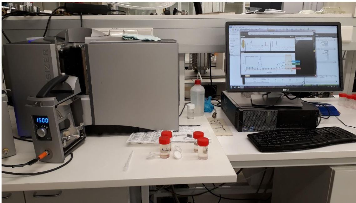
Kuva 12. Malvern Mastersizer 3000 ja näytteensyöttöyksikkönä Hydro SV.
