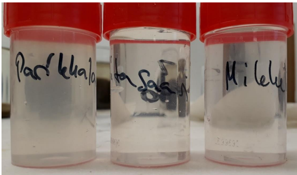
Kuva 32. Eri paikkakuntien lietteiden laskeutuksessa muodostuneet kirkasteet. Vasemmalta oikealle: Parikkala, Viitasaari ja Mikkeli
