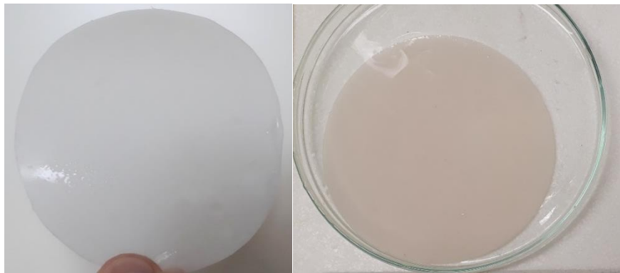
Kuva 8. Esimerkkikalvo uudesta ja käytetystä kalvosta. Uusi kalvo kuvassa vasemmalla, käytetty oikealla. Käytetyistä kalvoista suurin osa oli pinnaltaan puhtaan näköisiä.
