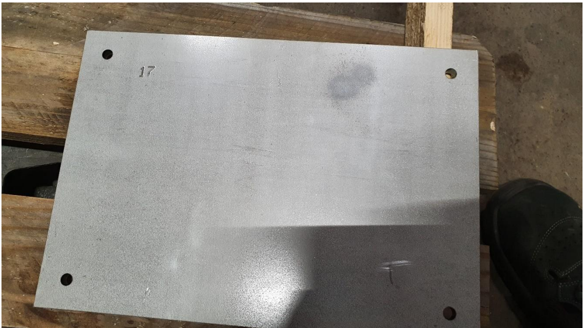
Kuva 29. Koekappaleen 17 pintaan jäi paineilmasta epäpuhtautta.
