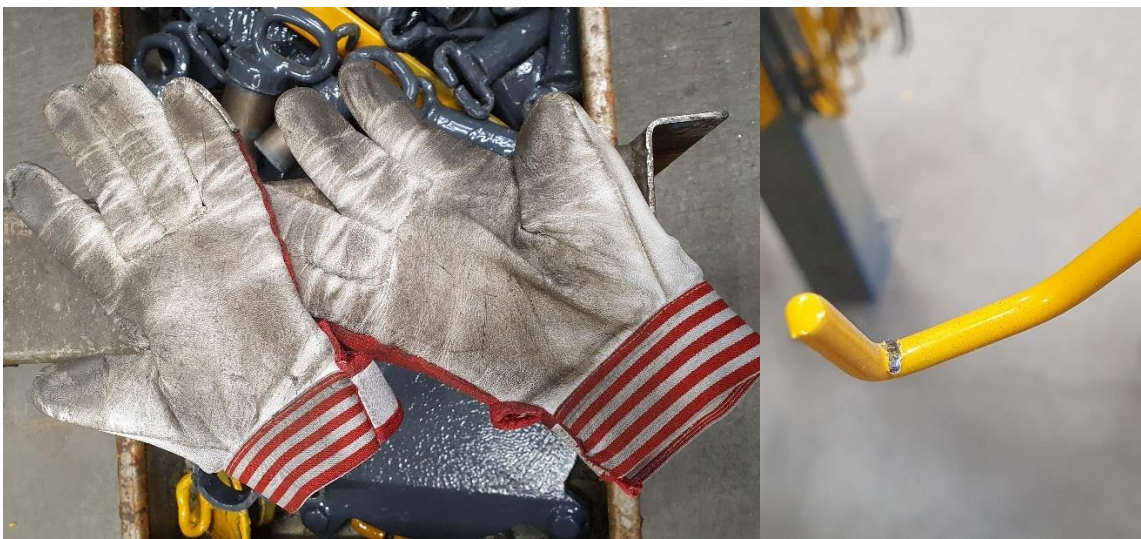
Kuva 32. Likaiset hanskat ja huonosti maadoittava ripustuskoukku, joita käytettiin testauksessa.
