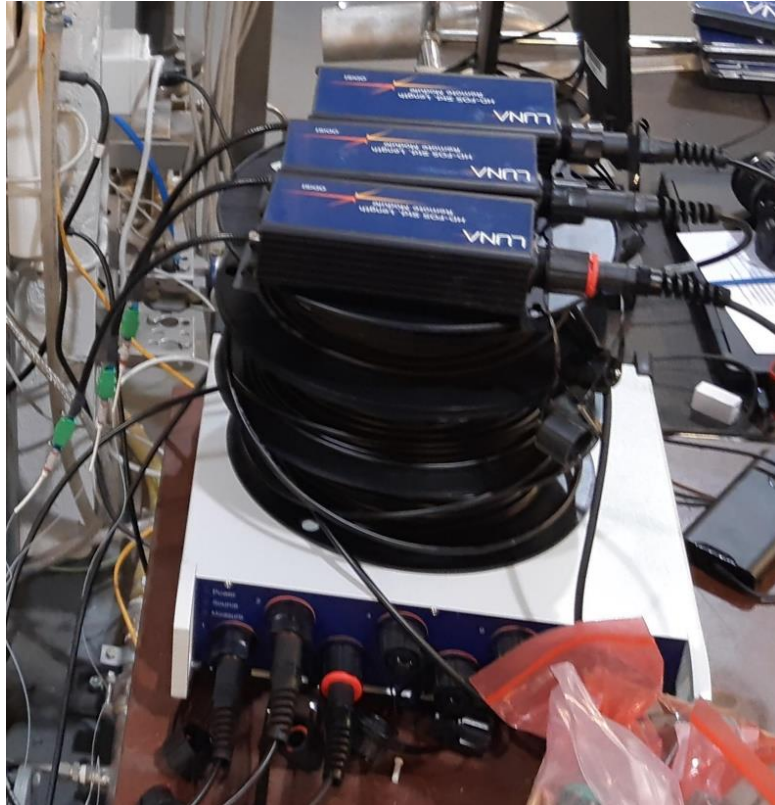
Kuva 2. Mittauksissa käytetty mittalaitteisto. Alimmaisena on mittauslaite, keskellä on kolmen eri valokuidun jatkokuidut ja niiden päällä jatkokuidun muuntomoduuli.
