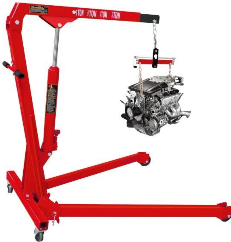
Kuva 9. Yksinkertainen hydraulikäyttöinen puominostin. (CARiD 2019)
