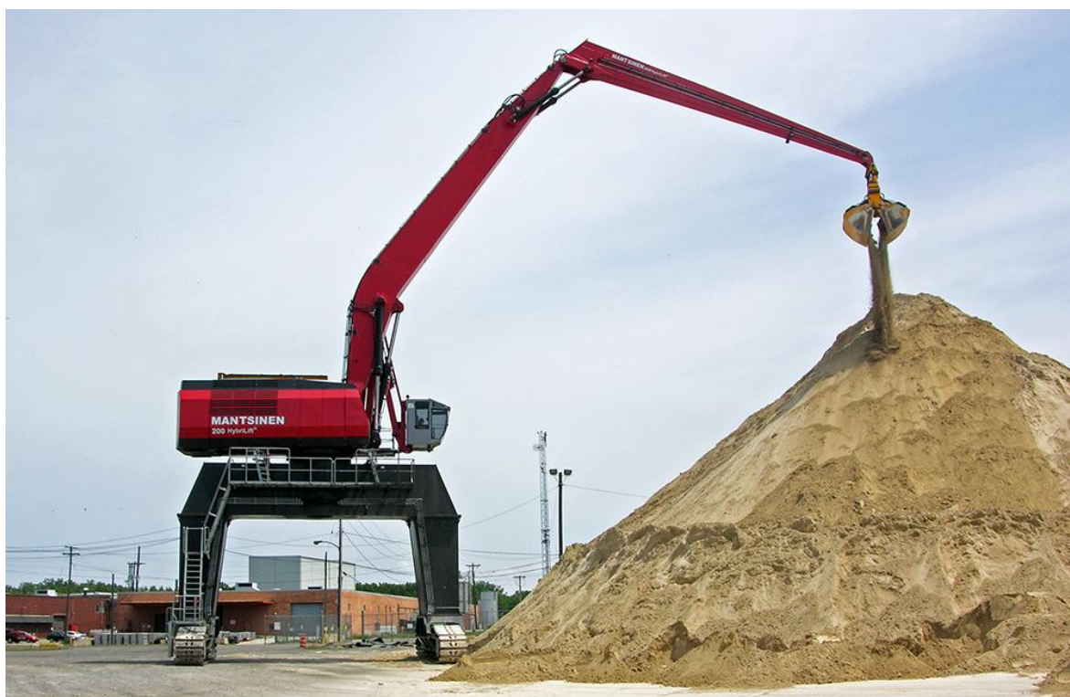
Kuva 1. Mantsinen 200 R Hybrilift käsittelemässä irtotavaraa. (Mantsinen Group 2019a)
