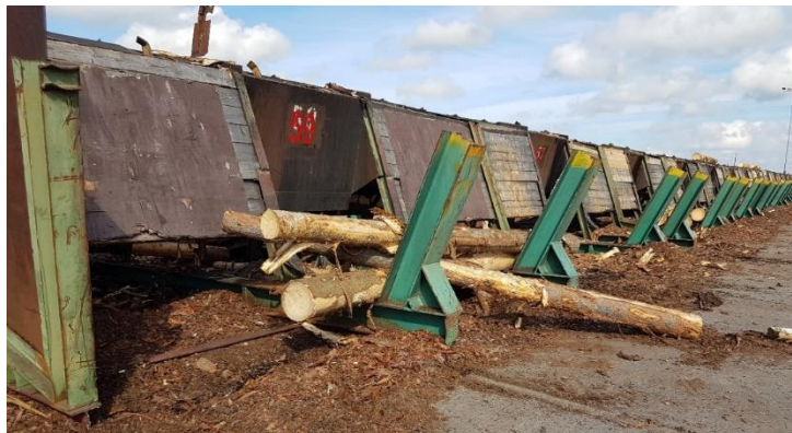
Kuva 2 Tukinlajittelulinjan lokeroita. Kuvassa yksi tukeista potkaistu liian myöhään.
