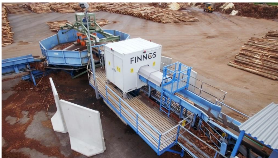
Kuva 1 Finnos Fusion mittauskontti kuljettimelle asennettuna
