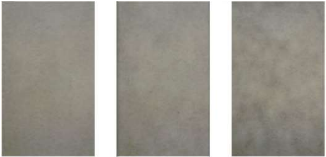
Kuva 37 Rungon perälaatikkosakeuden vaikutus kartongin ulkonäköön
