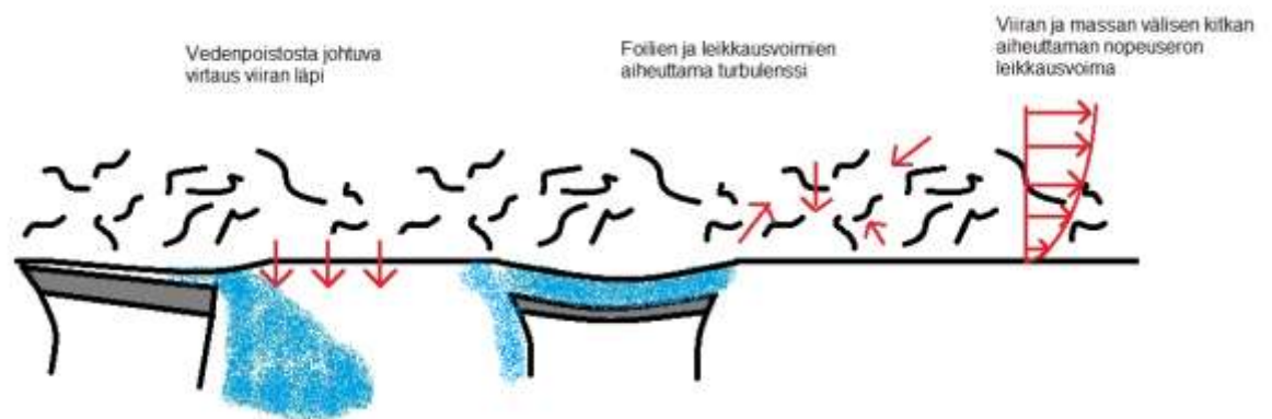
Kuva 4 Viiralla massaan kohdistuvat hydrodynaamiset voimat (Hägglom Ahnger & Komulainen, 2005) (Mukailtu)
