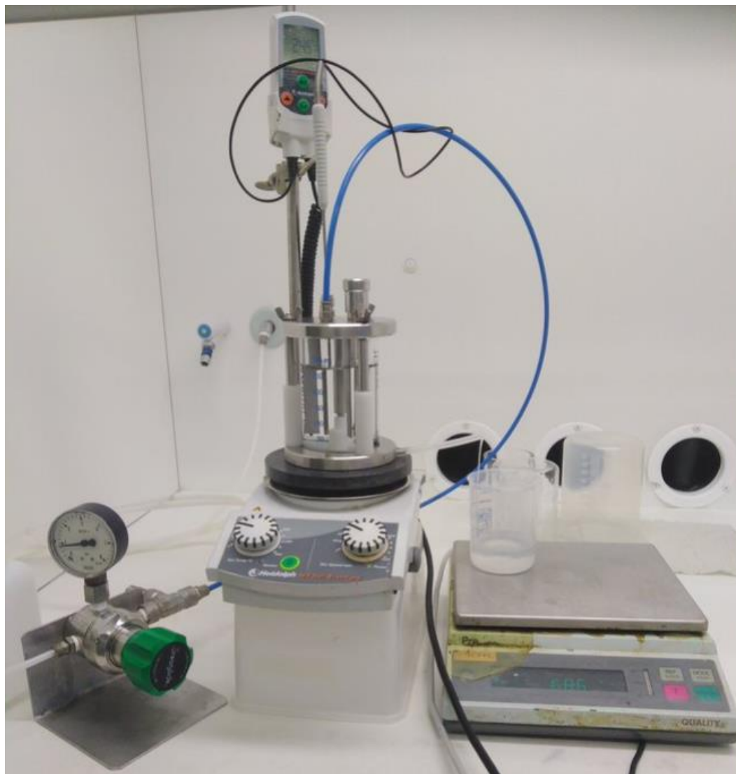
Kuva 2. Suodatuksessa käytetty Amicon-laitteisto. Kuvan 2 oikeassa alakulmassa on Swagelok:in valmistama painemittari, jolla säädetään näyteastiaan tulevan typ-pikaasun painetta. Näytteen lämpötilaan mitataan Heidolph EKT Hei-Con lämpömittarilla. Näyteastia on Heidolph MR Hei-Standard lämpölevyllisen magneettisekoittimen päällä. Kuvan vasemmassa alakulmassa on TEOPAL SWISS QUALITY- vaaka, jolla permeaatin massa mitattiin 3 tai 5 sekunnin välein.
