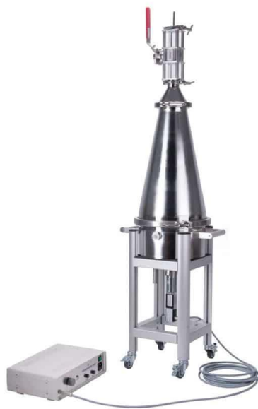
Kuva 7. MPSS-laitteisto, jolla voidaan erottaa mikromuoveja sedimenttinäytteestä. Lähde: https://www.hydrobios.de/ .
