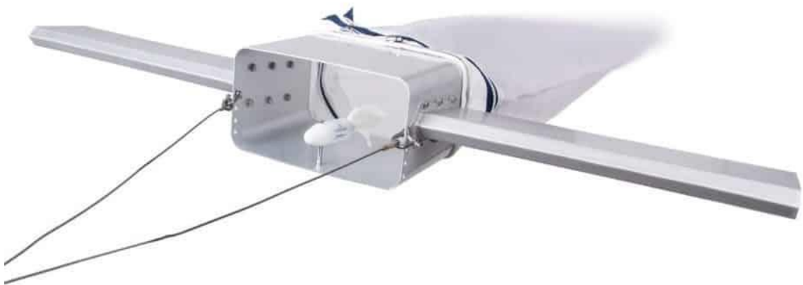
Kuva 6. Pintavesissä esiintyvien mikromuovinäytteiden keräämisen käytetty manta-trooli. Lähde: https://www.hydrobios.de/ .
