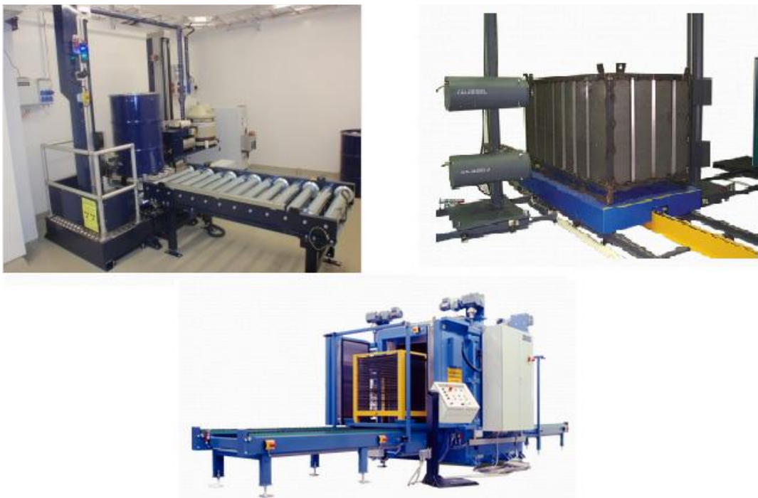
Kuva 8. Erilaisia gammaspektrometrisia monitoreita. Ylhäällä vasemmalla Loviisassa käytössä oleva huoltojätetyynyrimittauslaite A.N Technology Ltd. Series 3500 Segmented Gamma-Scanner 340, ylhäällä oikealla Mirion Technologiesin valmistama WM2500 Modular Gamma Box Counter ja alhaalla Mirion Technologiesin RTM644Inc valvonnasta vapautus -monitori suurelle jätemäärälle. (Mirion Technologies, 2020)
