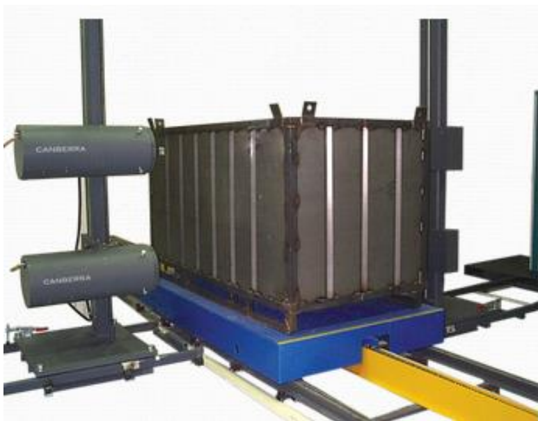
Kuva 11. Mirion Technologiesin WM-2500 Gamma Box Counter -tyylinen mittauskokoontalo. (Mirion Technologies, 2020)
