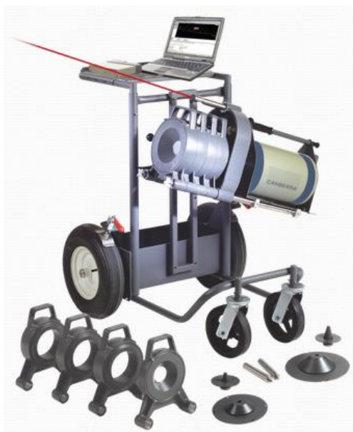
Kuva 10. Mirion Technologies:n valmistama ISOCS-laitteisto ISOXSHLD-pakettina, joka sisältää peruslaitteiston lisäksi myös lyijysuojat ja 30°, 90° ja 180° kollimaattorit. (Mirion Technologies, 2020)
