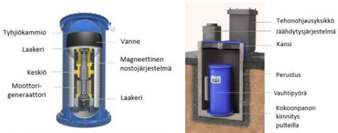
Kuva 17. Vauhtipyörän rakenne (Santeri Honkanen, Mekaaniset energiavarastot).
