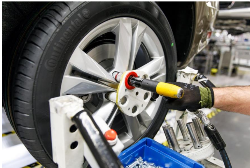
Kuva 8. Portugalilaisen autotehtaan Volkswagen Autoeuropan käyttämä lisäävällä valmistuksella tuotettu jigi vanteen asennuksen aikaista suojaamista varten (de Vries, 2017).
