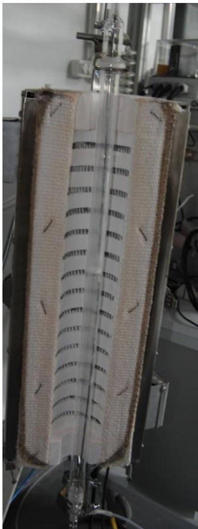
Kuva 7. BenchScale-laitteiston 60 cm pitkä putkiuuni.
