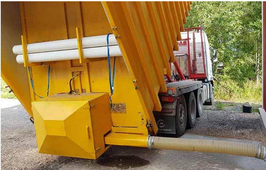
Kuva 3. Hakekontin tyhjennys puhaltamalla konttiin asennetulla JYJ700-puhaltimella. (Lämpösi Oy 2019).
