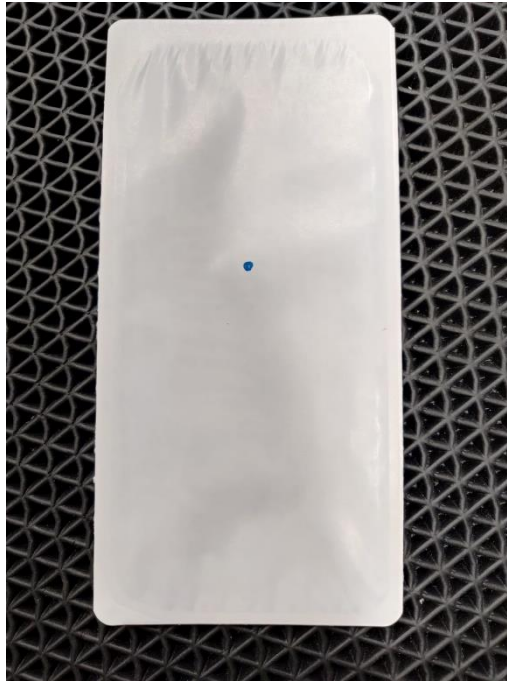
Kuva 14. Muotoillulla työkalulla suljettu sauma. Kalvomateriaalina LumiFlex 70 + 15 PE ja saumauslämpötila 130 °C. Sininen piste vuolan keskellä syntyy värjäysliuoksen annostelusta.
