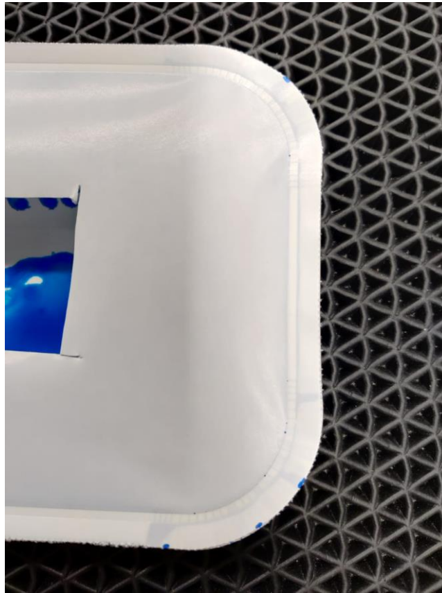
Kuva 12. Etanolilla tehty tunkeumanestetarkastelu. Kalvomateriaalina LumiFlex 70 + 15 PE, kartonkina Primeforma ja saumauslämpötila 130 °C.
