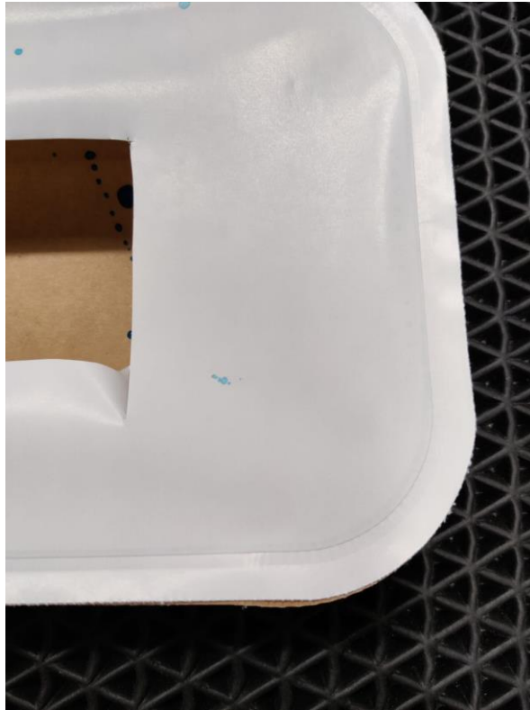
Kuva 13. Vedellä tehty tunkeumanestetarkastelu. Kalvomateriaalina LumiFlex 70 + 15 PE, kartonkina Duplex ja saumauslämpötila 150 °C.
