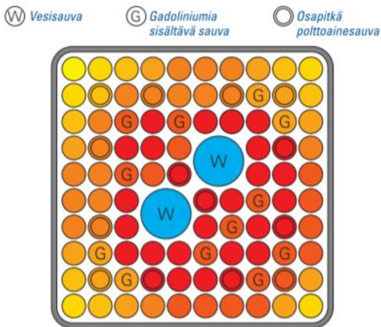
Kuva 2. GE14-tyyppinen polttoaine-elementti. Polttoainesauvojen väkevyyttä kuvataan eri väreillä. Punainen väri kuvaa suurempaa väkevöintiastetta. (TVO 2019, s.15)
