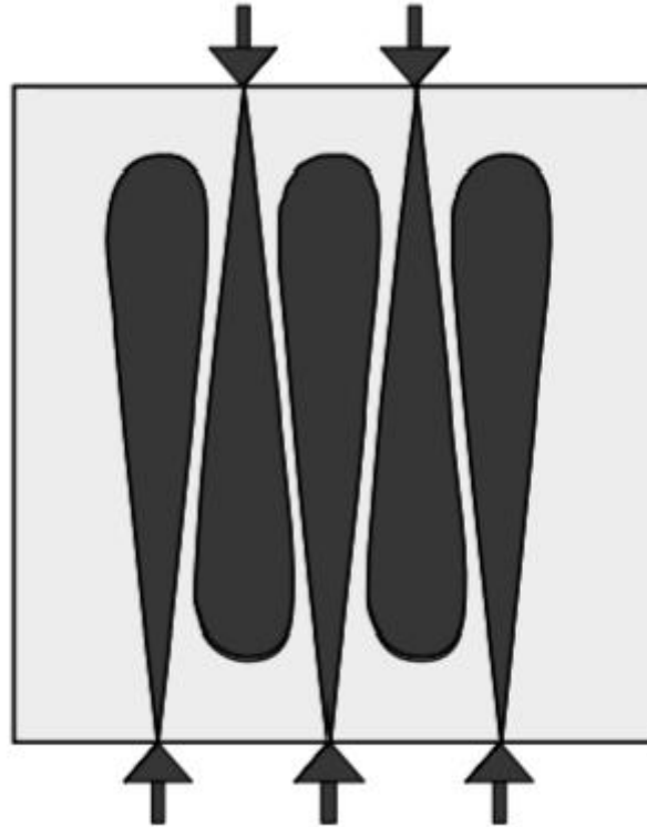
Kuva 10. Tertiääri-ilman syöttö soodakattilaan (muokattu lähteestä Wessel, 2015, 4)
