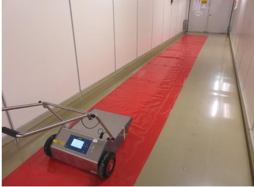
Kuva 5. Sokkotesti mittaradalla laitostenvälisellä yhdyskäytävällä. Näyte on piilotettu muovin alle.
