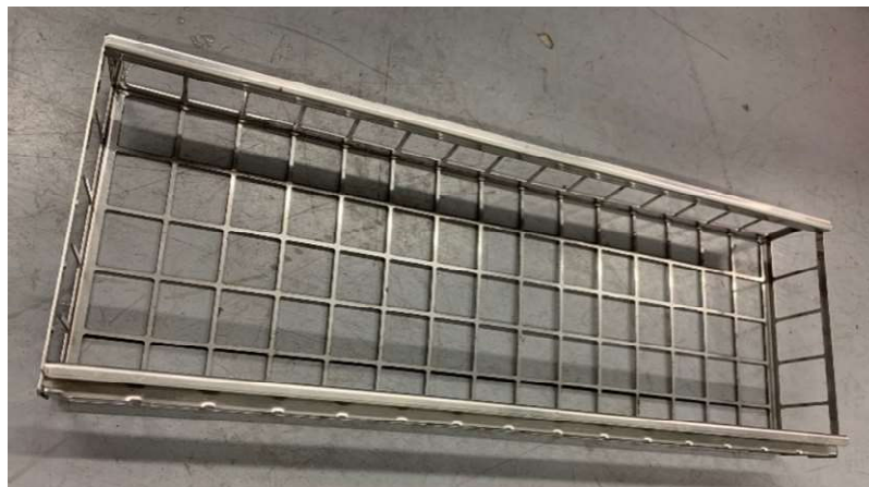
Kuva 28. Ohutlevystä valmistettu korin prototyyppi.
