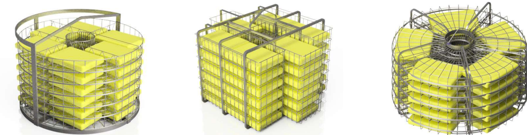
Kuva 15. Korimuunnelmat vasemmalta oikealle; pyöreä pinottava kori, suorakulmaiset ulosvedettävät korit sekä sektorimalliset korit.
