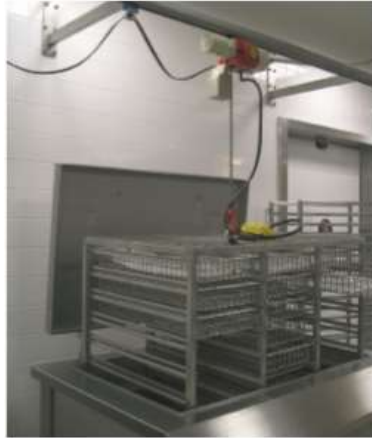
Kuva 16. Seinään tai kattoon asennettava nostin (Metos 2017, s. 11).
