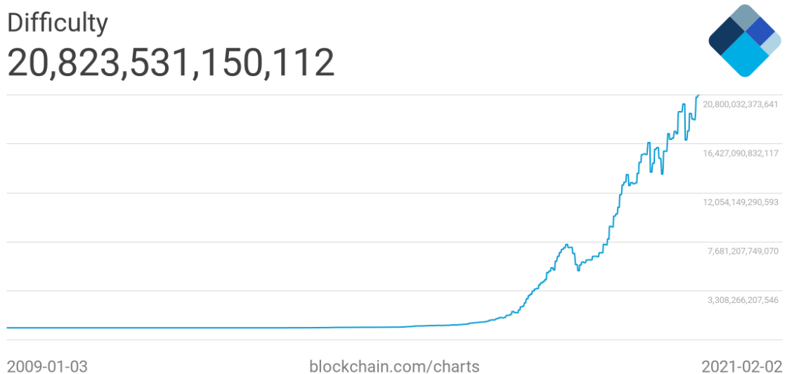
Kuva 7. Vaativuuden muutos vuodesta 2009 nykyhetkeen. Vaativuuden arvo kertoo sen, kuinka monta yritystä vaaditaan ennen oikean tuloksen löytämistä (Blockchain.com, 2021).
