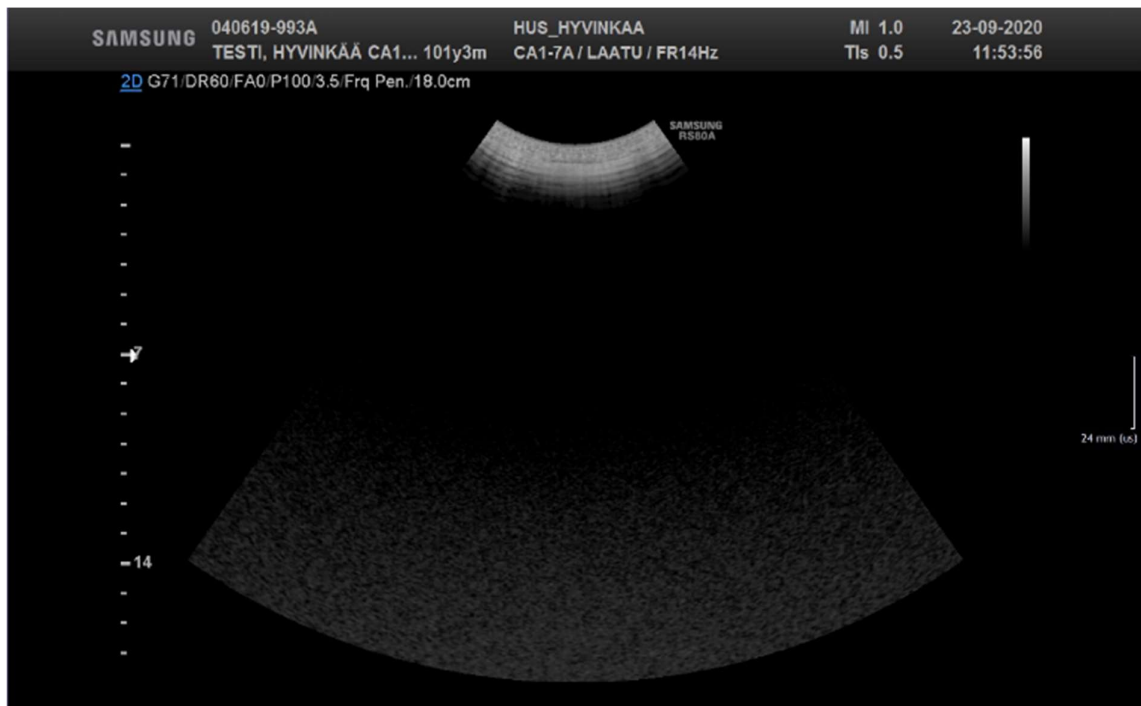
Kuva 10. Ilmakuva Samsung CA1-7A anturista, sarjanumero K0LJM3GJ600121Z, korjauksen jälkeen.
