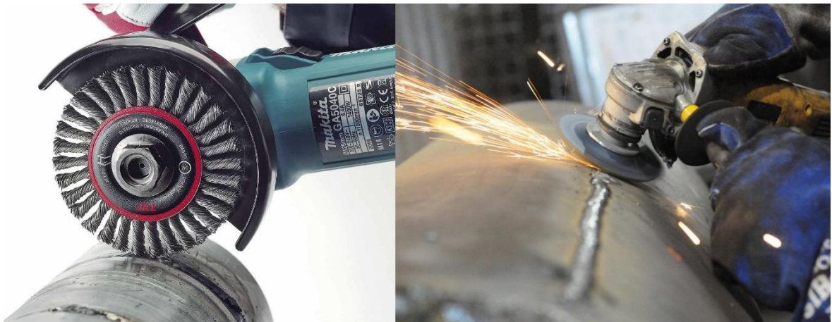
Kuvat 2 a ja b. Vasemmalla hitsatun sauman harjaus kulmahiomakoneen harjatyökälulla [4] ja oikealla sauman hionta kulmahiomakoneella. [5]
