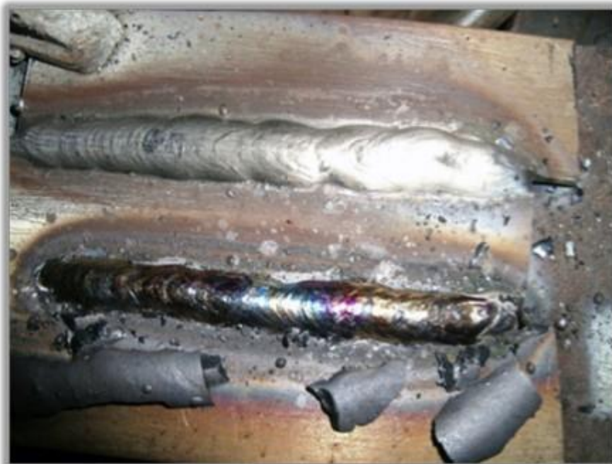
Kuva 1. Hitsisauma kuonanpoistoa ennen (alla) ja jälkeen. [3]
