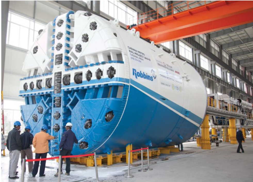
Kuva 11. Chennai metrotunnelin louhinnassa vuonna 2016 käytetty halkaisijaltaan 6,65 metrin Robbins TBM-tunnelipora. (The Robbins Company 2017.)
