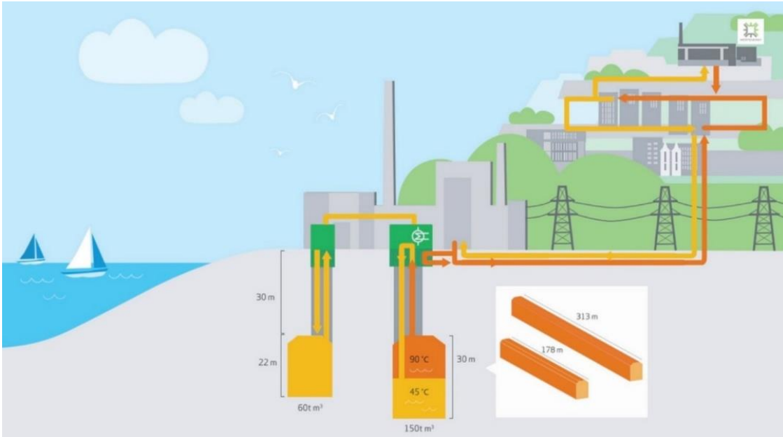
Kuva 12. Vaskiluodon luolalämpövarasto (Vaasan Sähkö 2019)
