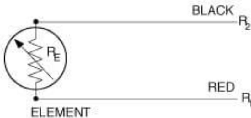
Kuva 4. 2-johtiminen PT-100 anturi. (Omega 2019a)
