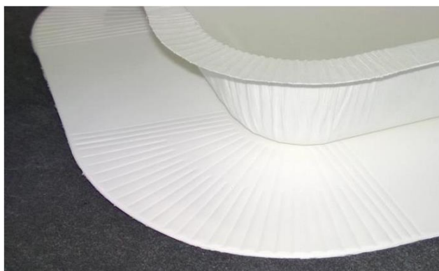
Kuva 4. Nuutatun aihion sekä puristetun vuoan kulma-alue (Leminen et al. 2013, s. 5706)
