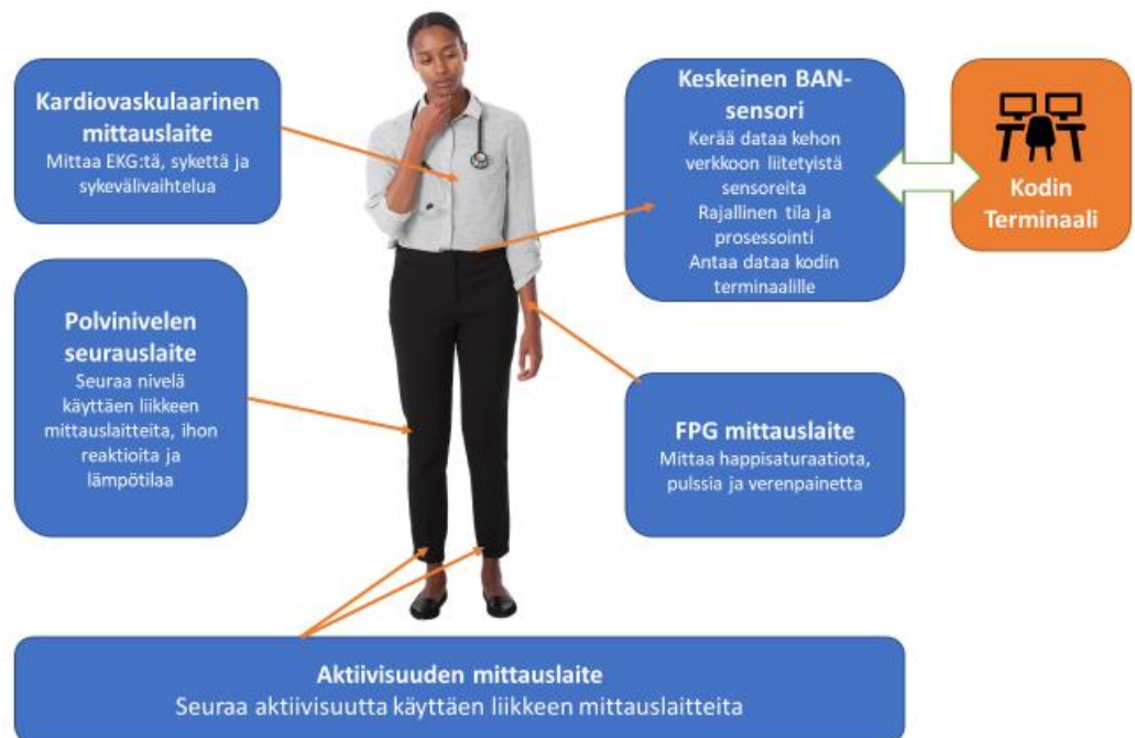
Kuva 6. Sensoreiden käyttäminen WBAN-tekniikan kanssa. Mukaillen Aghayj et al. (2017)
