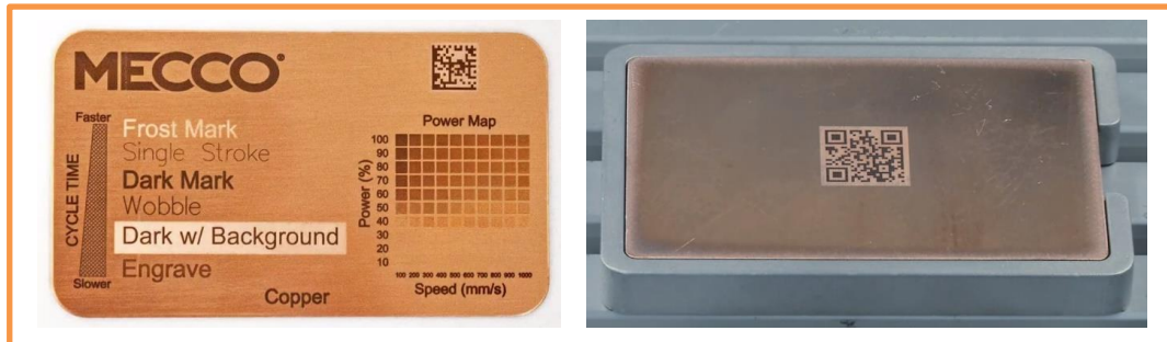
Kuva 2. Esimerkkejä lasermerkkauksesta (MECCO 2017; TRUMPFtube 2015)
