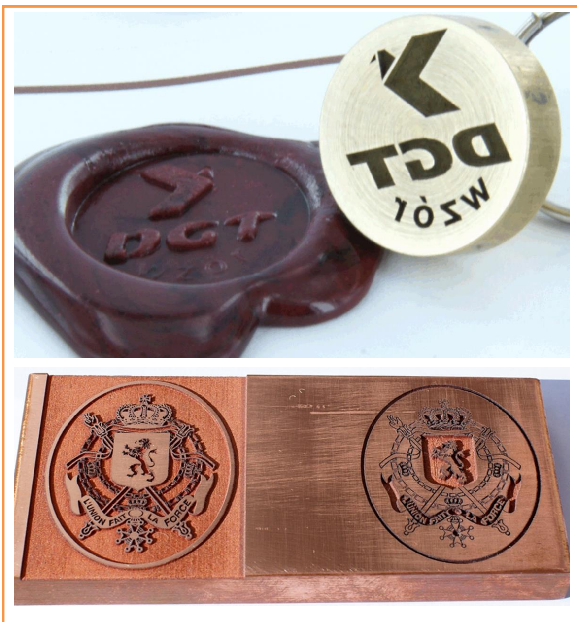
Kuva 6. Esimerkkejä syväkaiverruksesta (RMI Laser n.d.)
