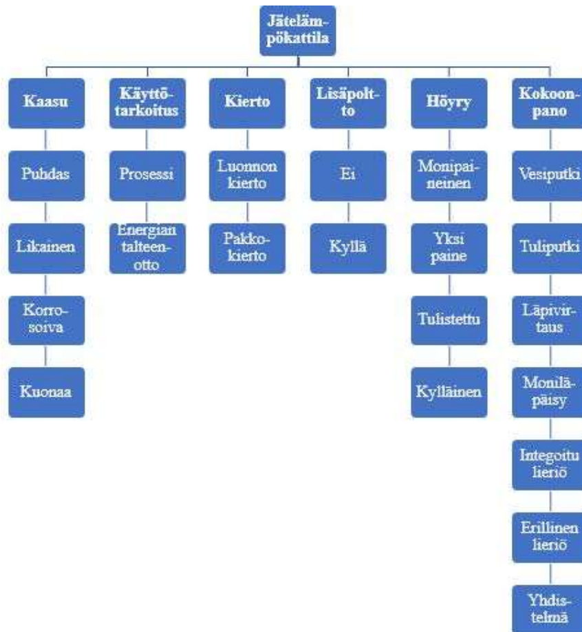
Kuva 9. Jätelämpökattilan rakenteeseen vaikuttavat tekijät (mukaillen Oakey 2011, s. 607).
