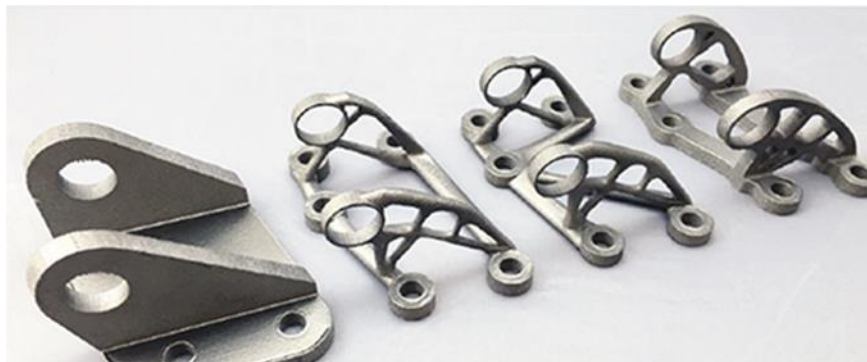
Kuva 1. Perinteisillä suunnittelu- ja valmistusmenetelmillä toteutettu korvake (vasemmalla) ja topologiaoptimoituja 3D-tulostettuja korvakkeita. (Samant 2018)
