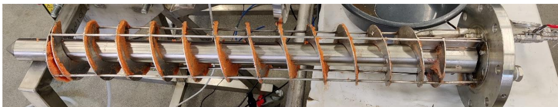
Kuva 62. 12-kierteinen spiraali ja ultraäänisauva poistettuna moduulin sisältä kahdeksannen pilot-mittakaavan kokeen jälkeen.
