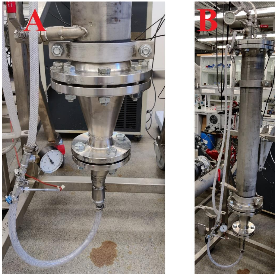
Kuva 44. Neljännessä pilot-mittakaavan kokeessa käytetty laitteisto. A) Ulostulo ohjattiin moduulin pohjalla letkuun kartion pidennyksen läpi. B) Moduulin ulostulosta letku kulki ylös ja toimi täten ylivuodolla moduulin sisällä olleen pinnan korkeuden mukaisesti.
