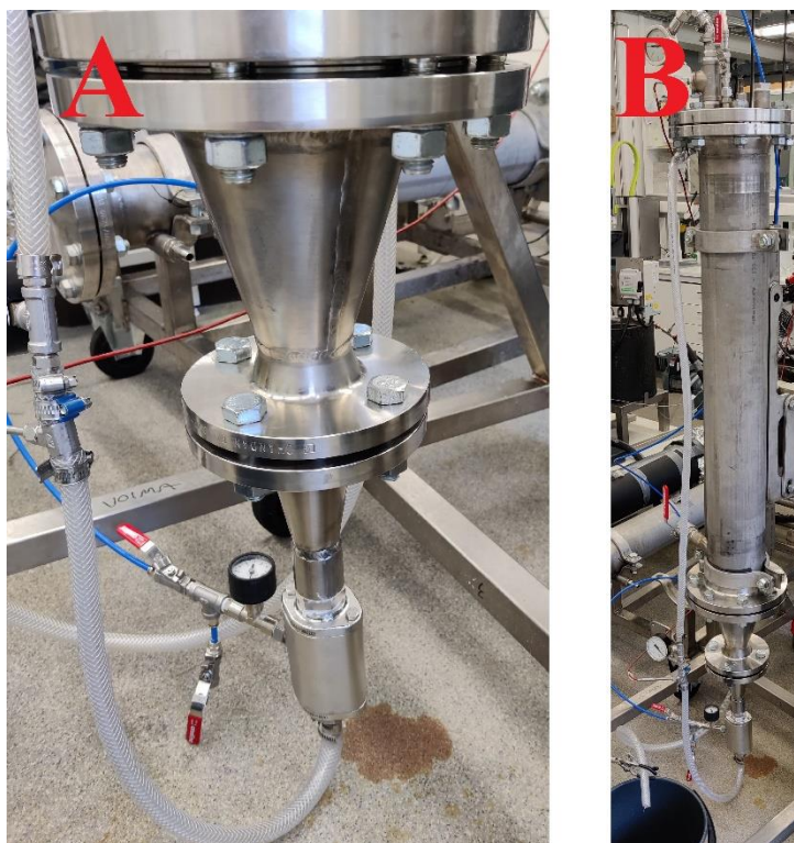
Kuva 57. Seitsemännessä pilot-mittakaavan kokeessa käytetty laitteisto. A) Moduulin alakartioon kiinnitetty kartion jatke sekä AKO VMC 25-letkuventtiili. B) Ulostulovirta ohjattiin ulos moduulin alapuolella olleen kartion jatkeen ja AKO VMC 25-letkuventtiilin kautta letkuun, joka kulki moduulin yläpinnan korkeudelle ja toimi täten ylivuodolla letkuventtiilin ollessa auki.
