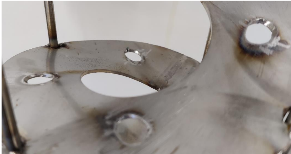
Kuva 39. 16-kierteen spiraalin ensimmäiselle kierrokselle porattiin neljä reikää, joiden halkaisija oli noin 1 cm.
