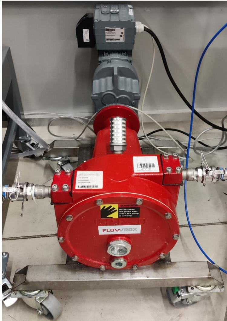
Kuva 13. Pilot-mittakaavan kokeissa ultraäänimoduulin syöttöpumppuna käytetty Flowrox LPP-D15 -letkupumppu.
