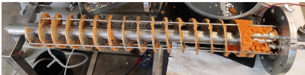
Kuva 36. 16-kierteinen spiraali ja ultraäänisauva poistettuna moduulin sisältä toisen pilot-mittakaavan kokeen jälkeen.
