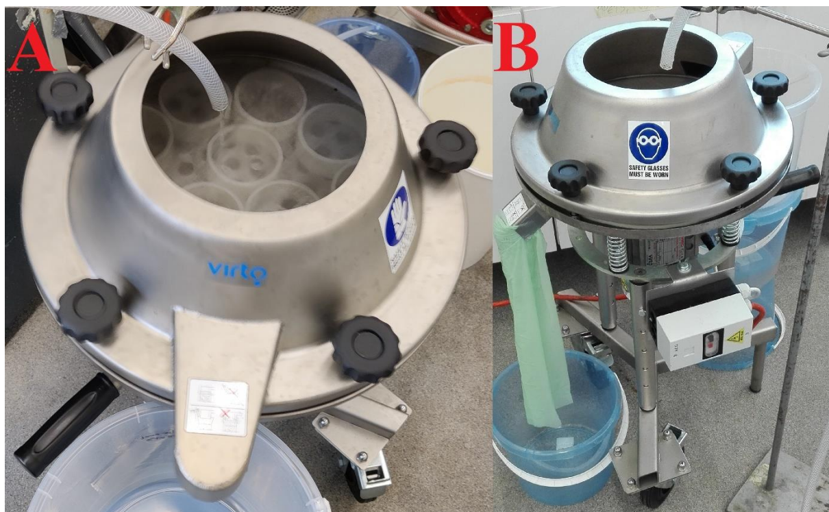
Kuva 15. Pilot-mittakaavan kokeissa käytetty Virto VPB 450-täryseula: A) kokeen aikana käytössä ja B) ennen kokeen aloitusta.
