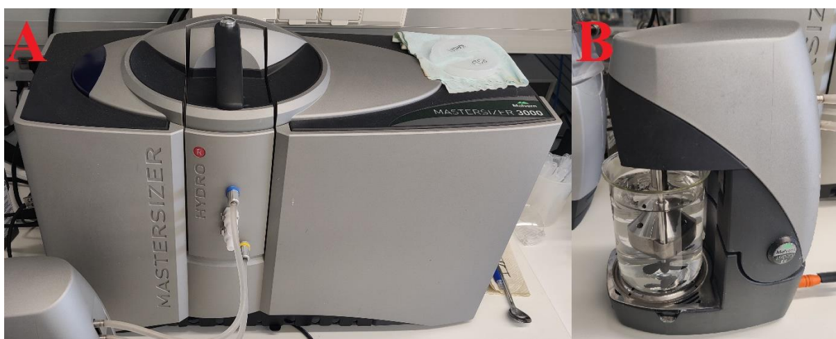
Liitekuva 2. A) Pienempien kiintoainepartikkelien partikkelikokoanalyysiä varten käytetty Malvern Mastersizer 3000-partikkelikokoanalysointilaitte. B) Malvern Mastersizer 3000-partikkelikokoanalysointilaitteen lisätarvikkeena ollut Hydro EV-dispersioyksikkö, jonka näytteenottopää oli liuotinta sisältävässä dekanterilasissa ennen mittauksen aloitusta.
