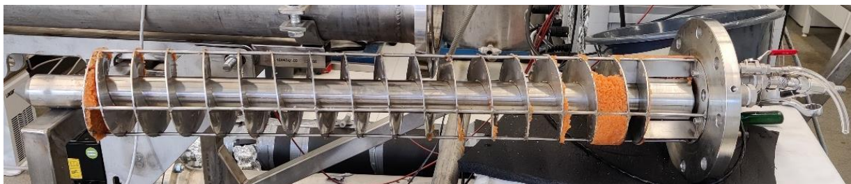
Kuva 34. 16-kierteinen spiraali ja ultraäänisauva poistettuna moduulin sisältä ensimmäisen pilotmittakaavan kokeen jälkeen.
