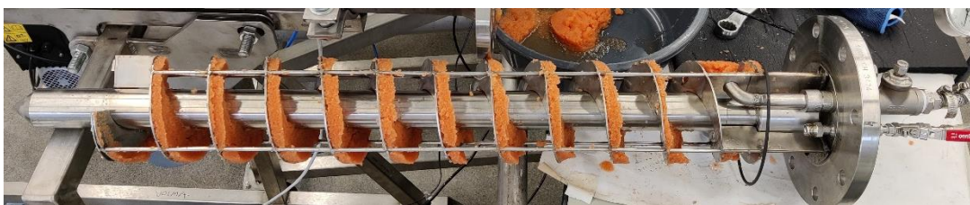
Kuva 53. 12-kierteinen spiraali ja ultraäänisauva poistettuna moduulin sisältä kuudennessä pilot-mittakaavan kokeen jälkeen.
