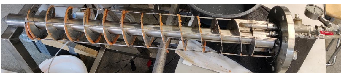
Kuva 49. 12-kierteinen spiraali ja ultraäänisauva poistettuna moduulin sisältä viidennen pilot-mittakaavan kokeen jälkeen.
