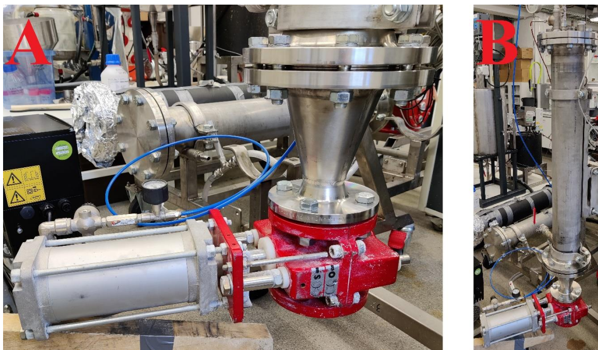
Kuva 48. Viidennessä pilot-mittakaavan kokeessa käytetty laitteisto. A) Moduulin alakartioon kiinnitetty Larox PVE 50 A6-202LUK-letkuventtiili. B) Ulostulovirta ohjattiin ulos moduulin alapuolella olleen Larox PVE 50 A6-202LUK-letkuventtiilin kautta.
