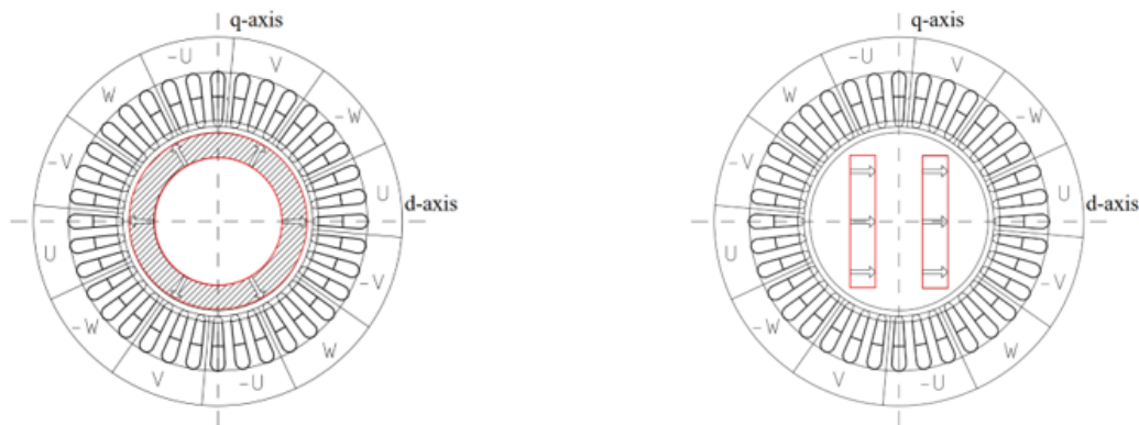
Kuva 2.14. Kestomagneettitahtikoneen isotrooppinen roottori (vasemmalla), jonka d- ja q-akseleilla ei ole induktanssieroa. D-q-tasossa anisotrooppisella roottorilla (oikealla) d-akselin induktanssi on pienempi kuin q-akselin, jolloin koneella on mahdollista tuottaa myös reluktanssivääntömomenttia. Koneen pitkittäinen d-akseli ja poikittainen q-akseli. Molemmissa tapauksissa p = 1 .
