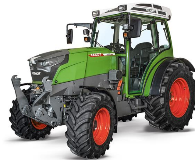
Kuva 1.8. Akkukäyttöinen täyssähkötraktori Fendt eVario (AGCO. e100 Vario).
